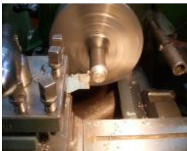
Rys. 10 – Obróbka nożem z płytkami ze stali SW7M: n = 450 \text{ obr/min} ; p = 0,25 \text{ m/min}
