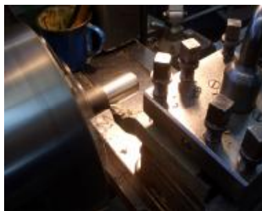
Rys. 11 – Obróbka nożem z płytkami z węgla spiekanego S10: n = 450 \text{ obr/min} ; p = 0,90 \text{ m/min}
