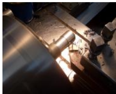
Rys. 12 – Obróbka nożem z płytkami z węgla spiekanego H10: n = 450 \text{ obr/min} ; p = 1 \text{ m/min}
