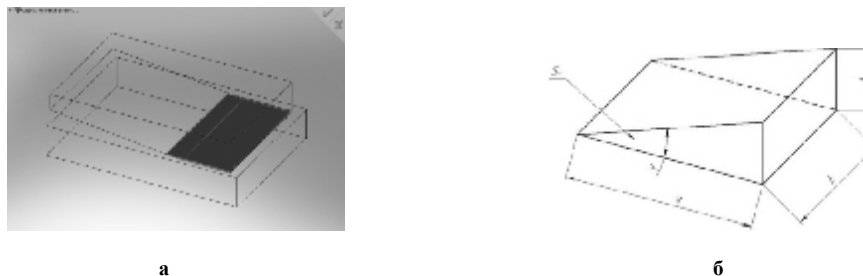
Рис. 3 – Схема развития пятна контакта при макрогеометрической приработке плоских поверхностей: а – зона приработки; б – геометрическое представление изнашиваемого материала; S_{nn} – площадь контакта плоского ползуна; \delta – толщина изнашиваемого материала; \gamma – угол перекоса; b – ширина детали
