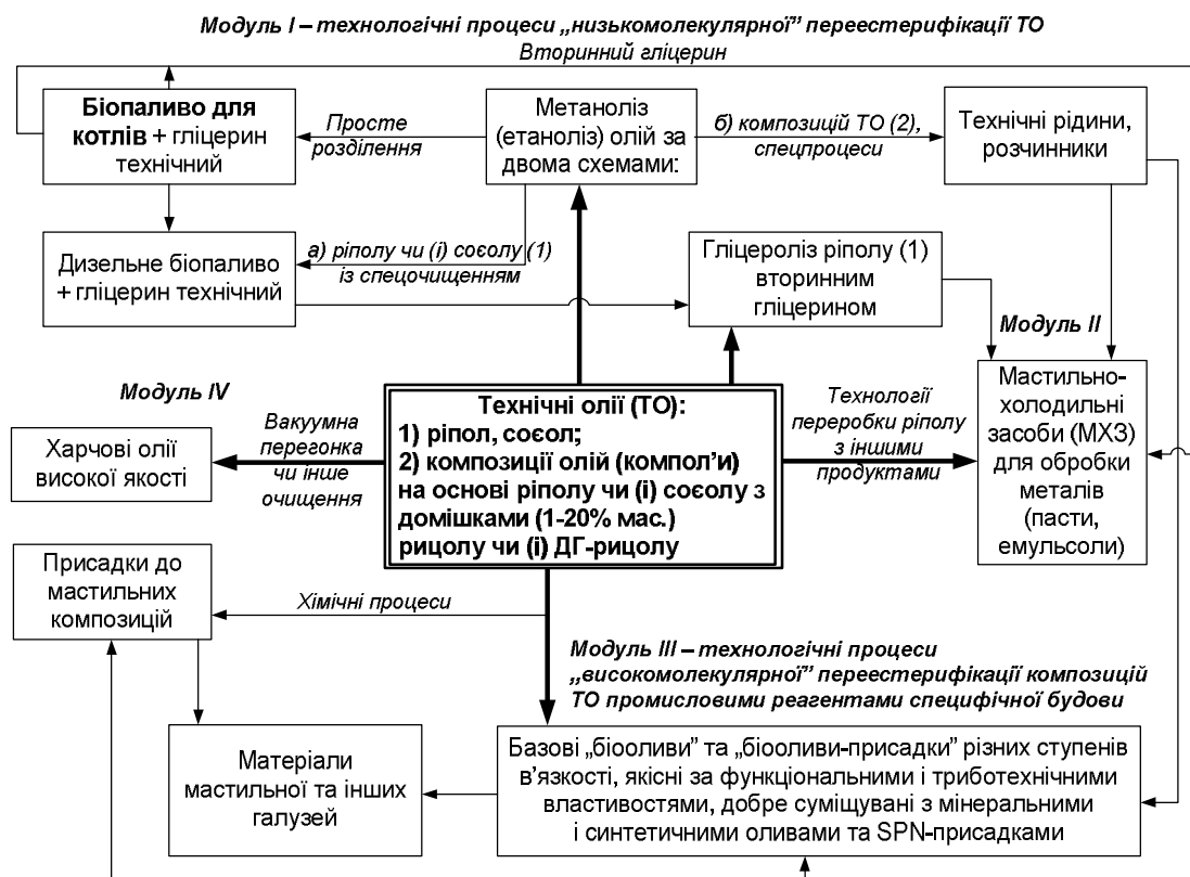
Рис. 1 – Структурно-системна модель проекту комплексної переробки технічних олій на біо синтетичні матеріали широкого асортименту та різних галузей призначень
