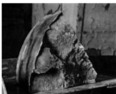
Рис. 2 – Излом металла по месту разрушения детали «Мундштук» (фрагмент)
