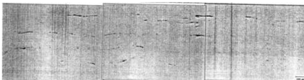
Рис. 11 – Загрязненность металла трамвайной оси неметаллическими включениями
