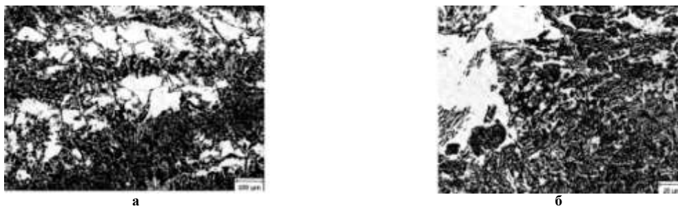
Рис. 6 – Микроструктура металла детали «Дорн 12» \times 100 (а) и \times 200 (б)
