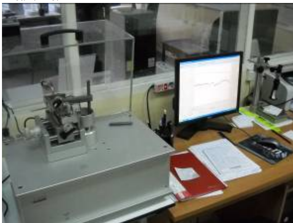
Fig. 1. Tribometer conjunction TRB – S – DE
