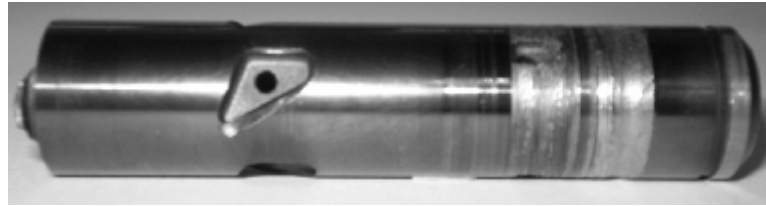
Рис. 1 – Ротор топливного насоса типа VRZ ZEXEL производства Японии
