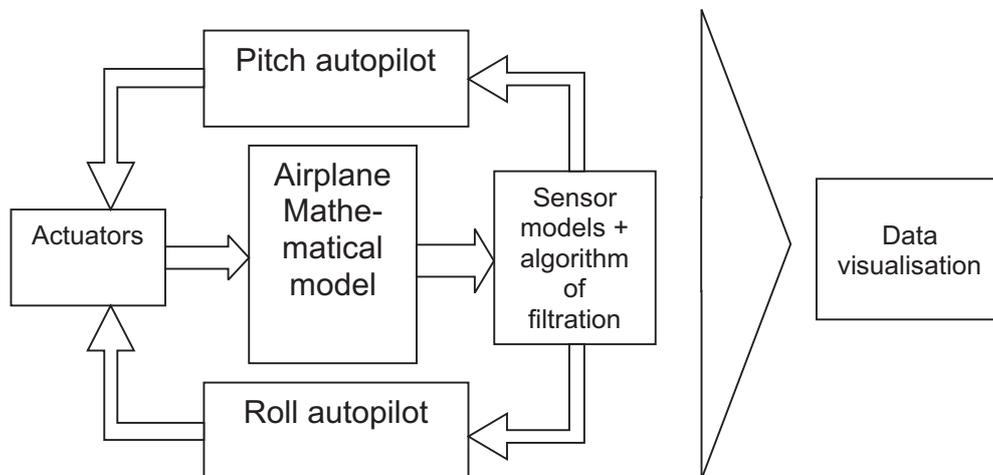
Fig. 5: Simulink<sup>®</sup> block scheme
