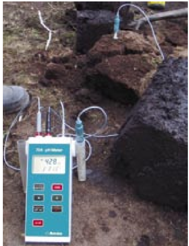
Figura 2. Determinación del potencial redox en campo. Nótese la lectura mayor de 400 mV en horizontes sulfúricos.
