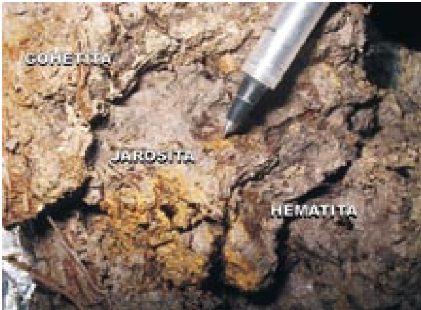
Figura 1. Los procesos redox que ocurren en horizontes sulfúricos de SSA del distrito de riego del Alto Chicamocha, se hacen evidentes a través del contraste de colores de las diferentes características redoximórficas con transformación de los minerales de Fe, S y Al.
