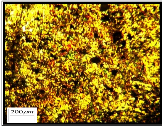
الشكل (٢٠) معدن اللحام (WM) لعينه سمك (2mm) ولزمن (8sec) غاز CO 2 .
