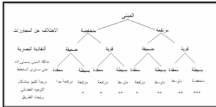
شكل 2 مصفوفة لتقييم وضوحية موضع دال والذي يمثل بنائية من اجل التوصل إلى قيمة أولية في مدى ضعف قدرته على الإدلال بالاعتماد على بعض الخصائص الشكلية والتخطيطية المصدر : ( 22 )
