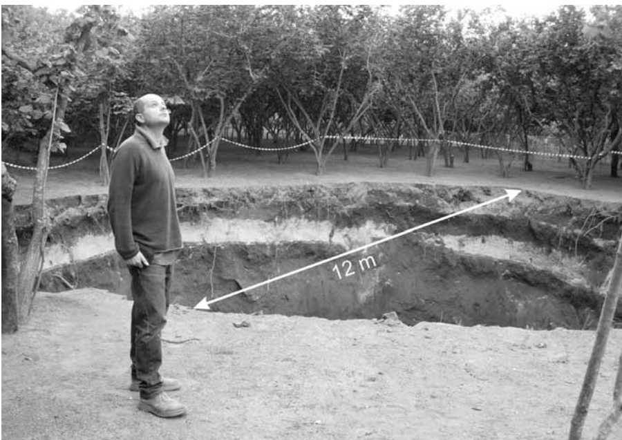
Fig. 5 - Il sinkhole di Contrada Petrosa pochi giorni dopo la sua formazione (25 giugno 2005; diametro circa 12m e profondità di circa 25m).
