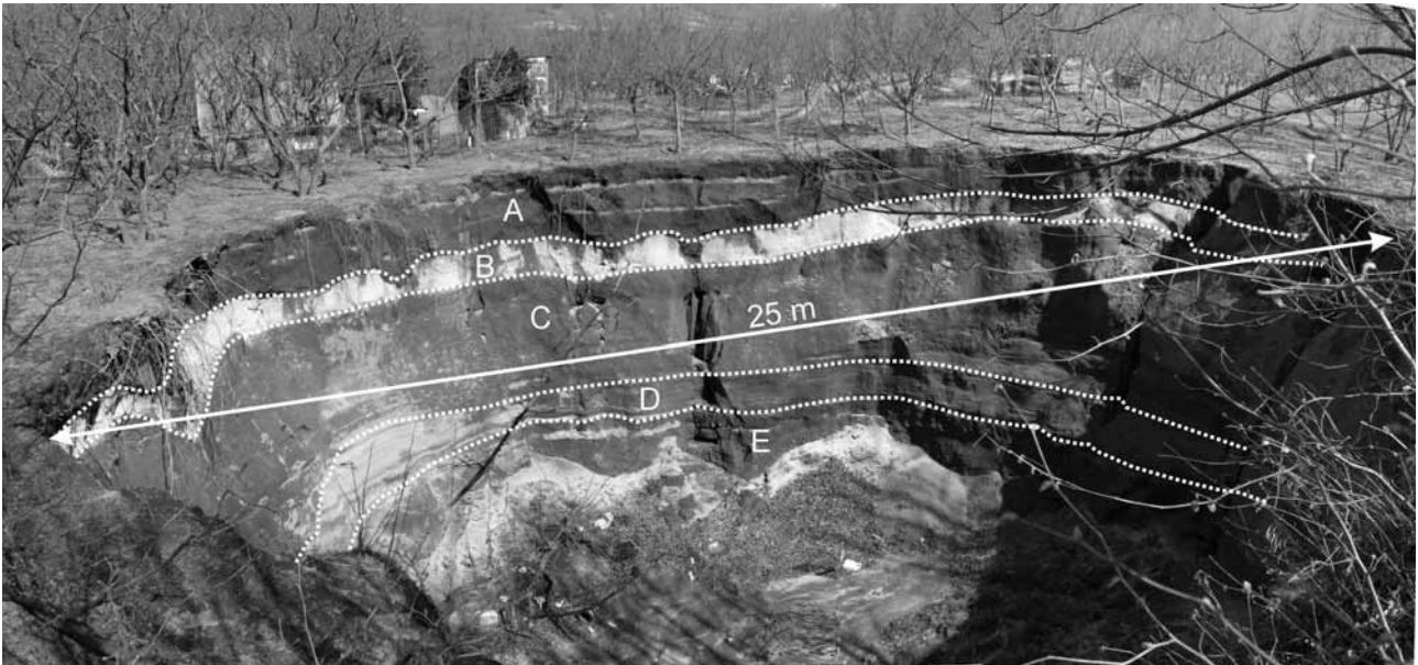
Fig. 6 - Panoramica della stratigrafia visibile lungo le pareti del sinkhole di Contrada Petrosa (foto del marzo 2007). Legenda: A) suoli recenti con due livelli di eruzioni vulcaniche storiche (472d.C. e 1631); B) pomici dell'eruzione vulcanica di Mercato/Ottaviano, 8000 anni fa; C) cineriti rimaneggiate (limi sabbiosi) con pomici e locali livelli di sabbie e paleosuoli; D) pomici grigie e scorie probabilmente riferibili all'eruzione di Agnano rimaneggiate in ambiente alluvionale; E) cineriti (limi sabbiosi) pedogenizzate con locali livelli di sabbie fini.
