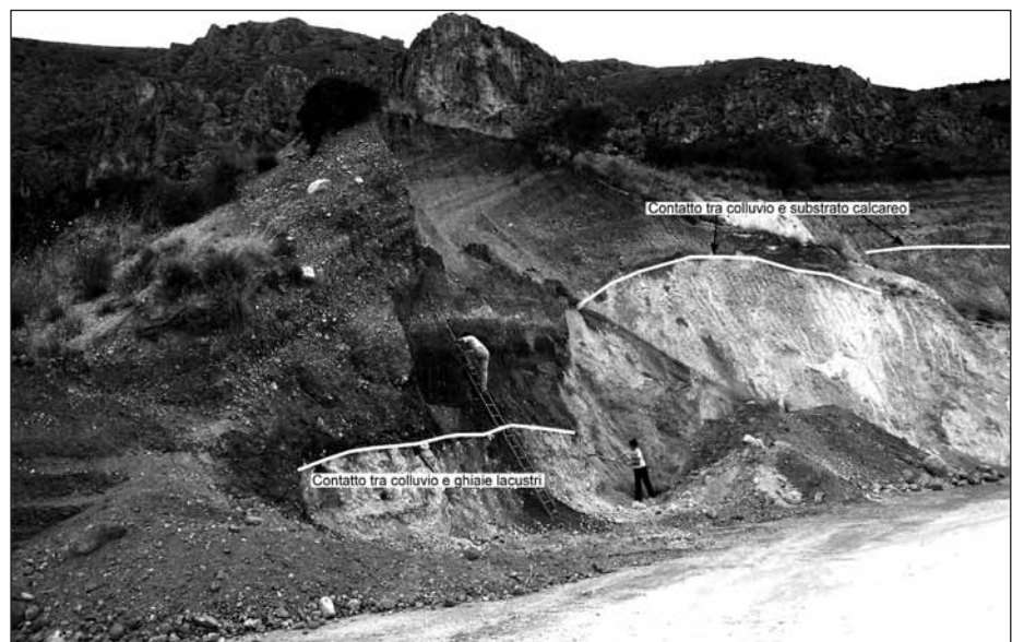
Fig. 3. Cava con fronte di scavo 1 (FS1 nel testo): evidenziati i contatti tra substrato calcareo, il colluvio e le ghiaie lacustri.
