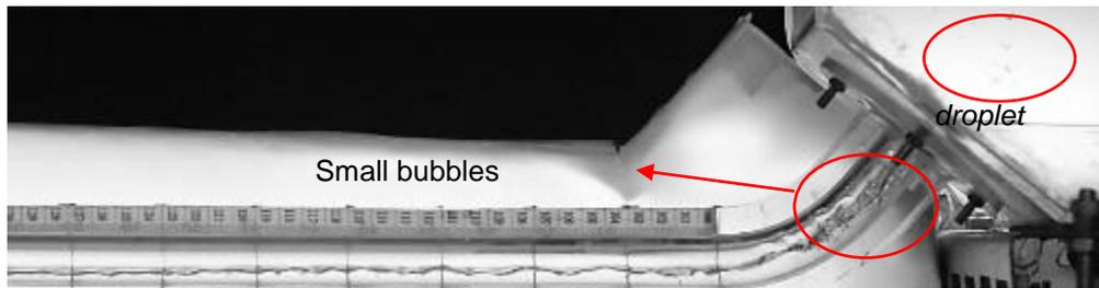
(d) Churn flow pattern and droplet generation for  $J_G= 2.47$  m/s dan  $J_L=0.020$  m/s
