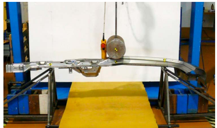
FIGURE 5: Drop test of an A-pillar OBRÁZEK 5: Pádová zkouška A sloupku
