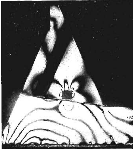
Rys. 2. Izochromy całkowite sekcji nieprzelewowej obciążonej ciężarem własnym
