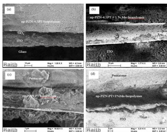
**Figure 2: SEM Images in transversal mode (a) DKRN-ITO2, (b) DKRN-ITO4, (c) DKRN-ITO7 and (d) DKRN-ITO8**
