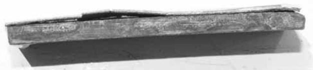
Rys. 14. Rozwarstwienie powłoki naniesionej proszkiem MetaCeram 28085 po badaniu odporności na udary cieplne Fig. 14. Delamination of coating sprayed with MetaCeram 28085 after thermal shock testing
