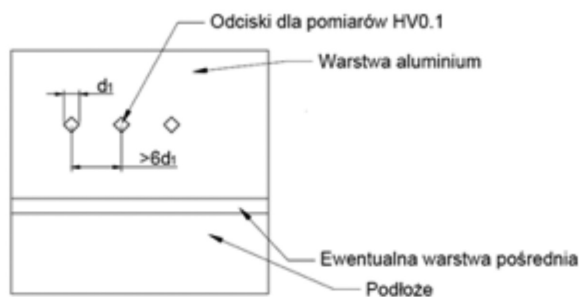
Rys. 3. Schemat rozmieszczenia odcisków do badań mikrotwardości Fig. 3. Scheme of arrangement of indentation points for microhardness testing
