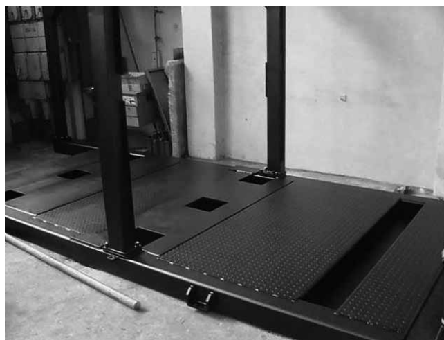
Rys. 3. Moduł podłogi (1800 x 3800 mm) wchodzącej w skład systemu kabin do instalacji i zabezpieczania robotów przemysłowych [6, 8]
