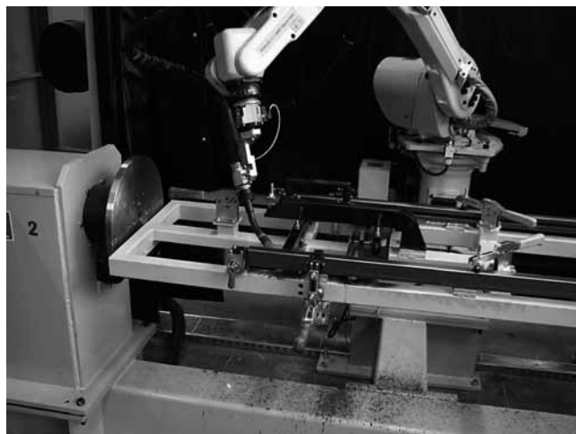
Rys. 2. Stanowisko osadzone na przestrzennej ramie, łączącej pozycjoner wrzecionowy (poszczególne moduły napędowe) z robotem (ZAP Robotyka)
