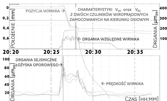
Rys. 5. Przebiegi wybranych sygnałów drgań w czasie problematycznego rozruchu
