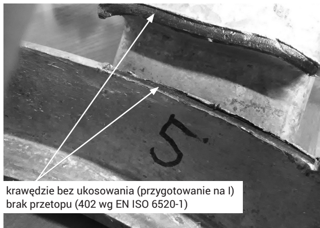
Rys. 5. Przełom złącza nr 5, ukosowanie I, brak przetopu 402 wg EN ISO 6520-1
