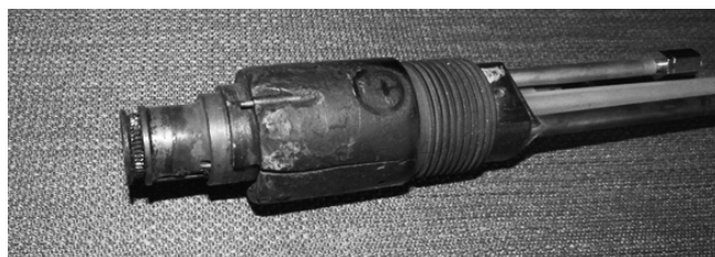
Rys. 4. Efekt pracy bez chłodzenia palnika – widoczny brak główki Fig. 4. Effect of work without cooling a torch – a lack of a head is visible
