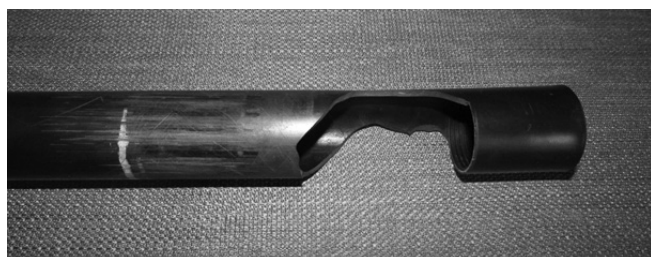
Rys. 7. Uszkodzony palnik i tuba przytrzymująca go w suporcie Fig. 7. Damaged torch and a tube holding it in the support
