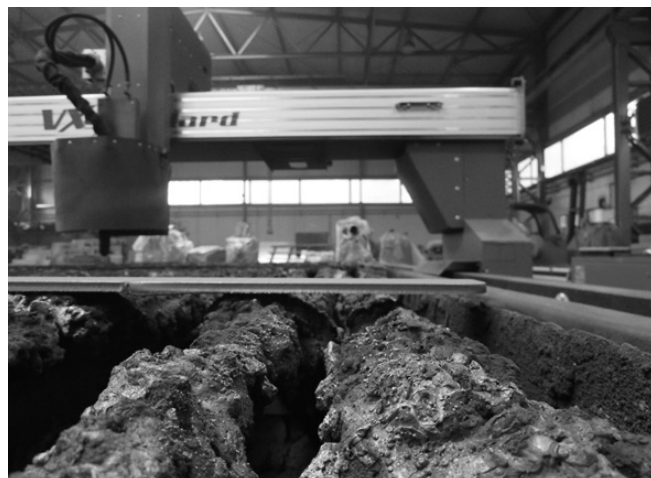
Rys. 8. Brak równomiernego podparcia ciętego materiału, spowodowana m.in. nadmierną ilością wypływki nagromadzonej na żebrowaniu Fig. 8. Lack of a steady support of the material being cut, caused by, among others, an excessive amount of flashing accumulated on the fins
