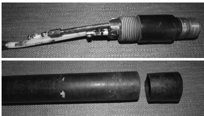
Rys. 10. Zgięty palnik i zniszczona tuba
