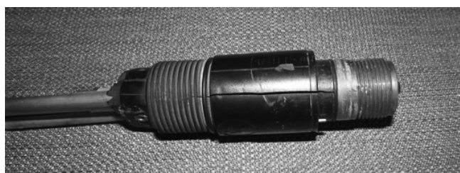
Rys. 5. Nowy palnik do cięcia plazmowego chłodzony cieczą Fig. 5. New liquid-cooled plasma cutting torch
