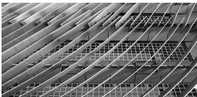
Rys. 11. Użebrowanie stołu plazmowego – kąt ok. 45^\circ
