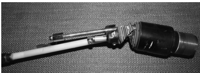
Rys. 6. Złamany palnik Fig. 6. Broken torch
