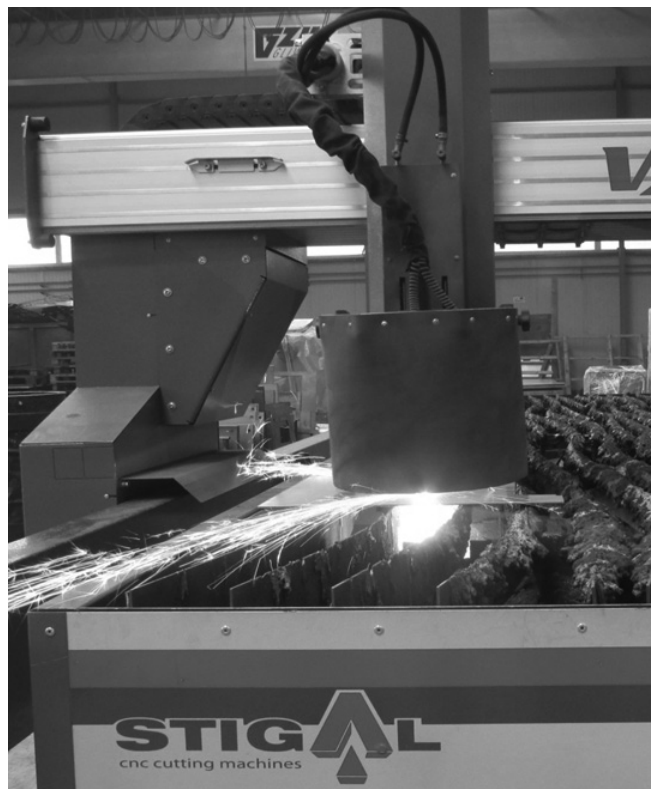
Rys. 15. Zbyt niskie opuszczenie osłon mogą uniemożliwiać dobrą obserwację
