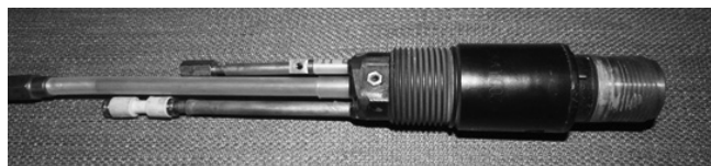
Rys. 3. Nowy palnik do cięcia plazmowego chłodzony cieczą Fig. 3. New liquid-cooled plasma cutting torch
